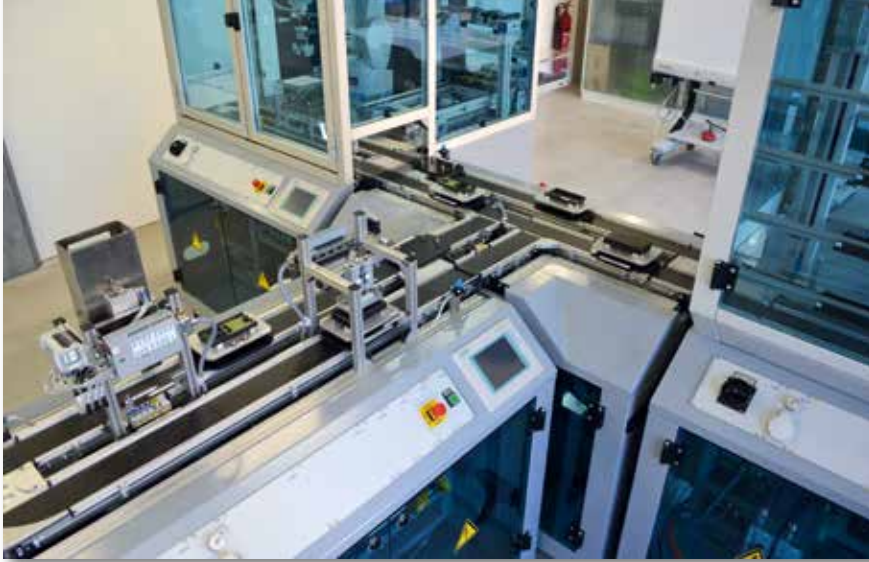
Die verschiedenen Grundmodule lassen sich flexibel verbinden und konfigurieren – das Grundmodul „Weiche“ erlaubt den Aufbau komplexer Produktionsstrecken.
