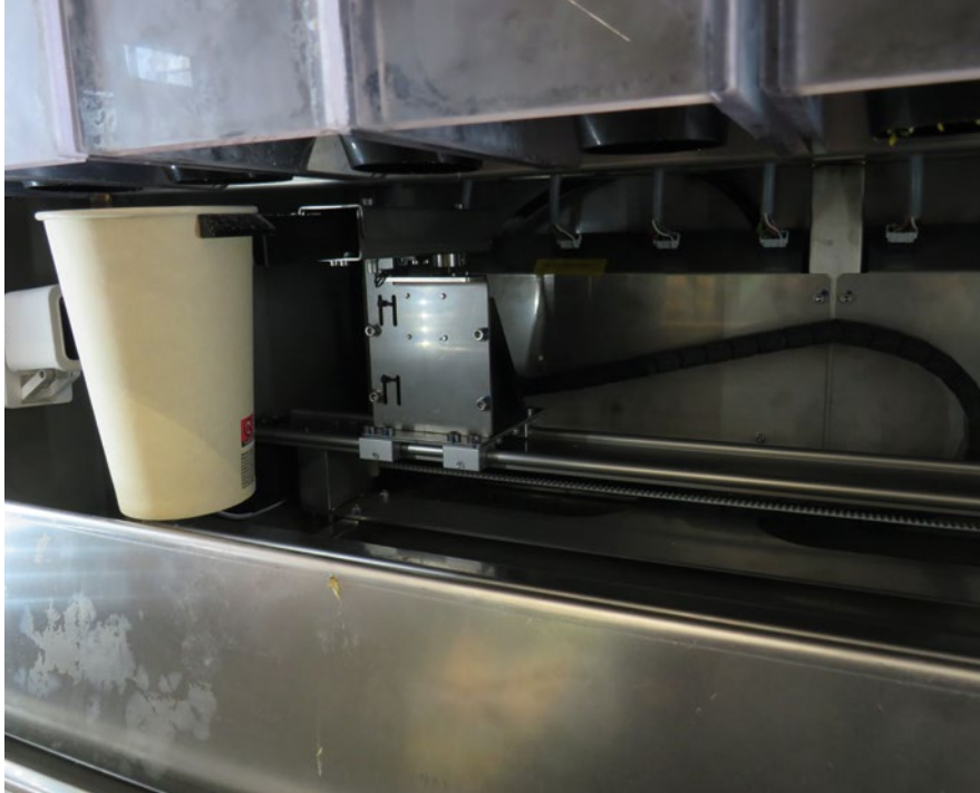
Drylin-W-Linearführungen mit vorgespannten Lagern. Auf der elektrischen Zahnriemenachse ZLW-1040 fährt der Roboterarm mit dem Becher an den Fruchtstationen vorbei
