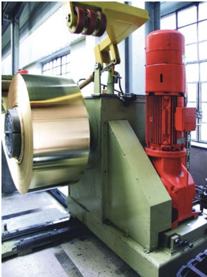
Wickler und andere hochwertige Applikationen erfordern vektorgeregelte Antriebe wie Applikationsumrichter der Gerätefamilie Movidrive. Mit dem neuen Verfahren VFCPlus ist diese Anwendung auch ohne Geber möglich.
