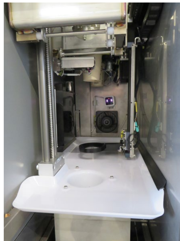
Die vertikale Positionierung von Becher und Mixer erfolgt leise und nahezu vibrationsfrei mit einem Linearmodul SLW-1660 mit Steilgewindespindel. Die Ausgabe des Smoothies übernimmt ein Linearmodul SHT-08. Bilder: Igus
