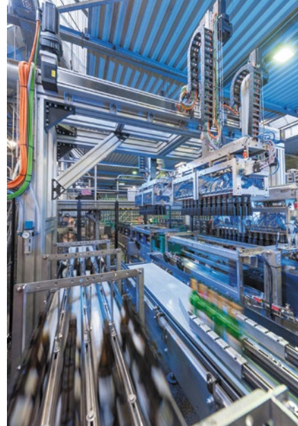
Aus Aluminium-Schwerlastprofilen und Linearachsen vom Typ RK DuoLine 160 Z konstruierte RK Rose+Krieger zwei leistungsstarke Handlingportale für eine Leergutsortieranlage.
