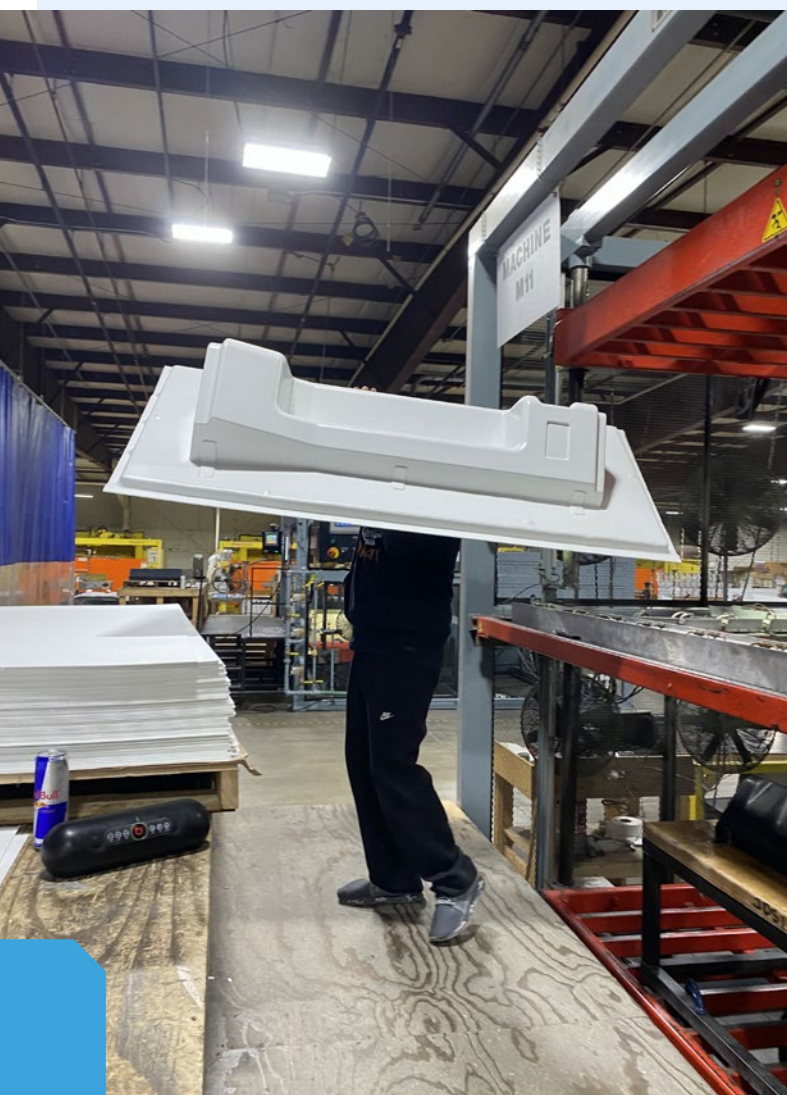
Endgültige unbeschnittene Platte, thermogeformt bei Duo Form unter Verwendung einer 3D-gedruckten Form, die mit der Pelletextrusionsplattform Titan von 3D Systems gedruckt wurde.
