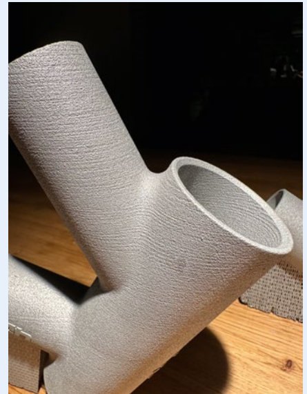
Das 3D-Druck-Aluminiumbauteil dient als Verbindungselement.
