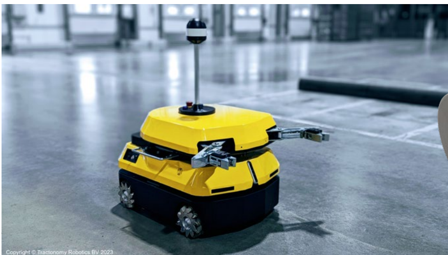
Beim Ziehen schwerer Lasten mit hohen Geschwindigkeiten wird die Bremskraft umso wichtiger. Deshalb ist der ATR2 mit integrierten Bremsen und einem 360-Grad-Sicherheitssystem ausgestattet, das Kollisionen verhindert.
