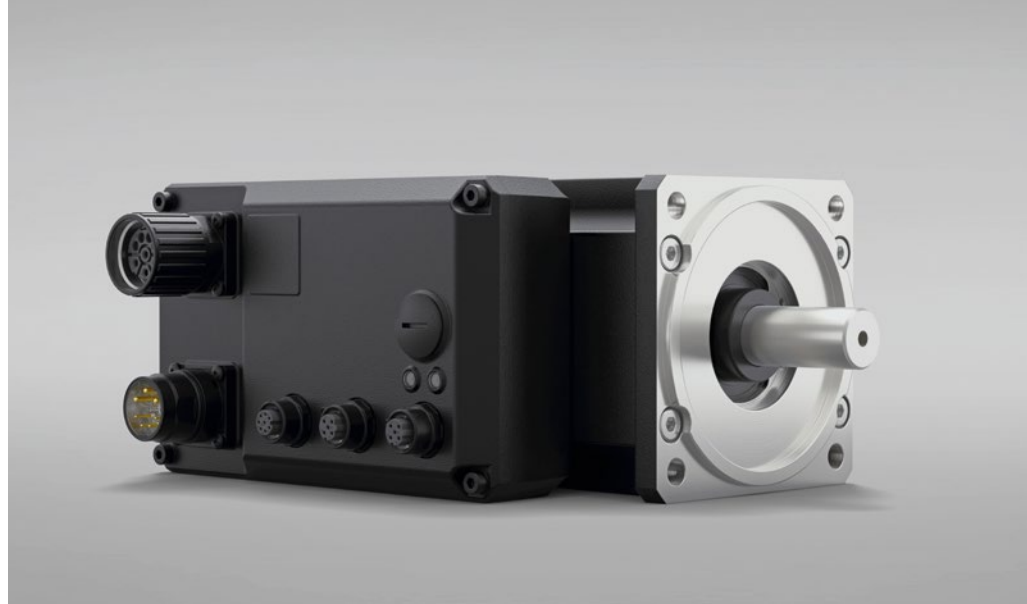
Der Wechselrichter sitzt hier direkt verdrahtet auf dem Servomotor. Damit entsteht eine mechatronische Funktionseinheit, die viel Platz spart.
