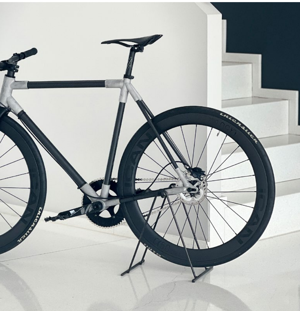
Das 3D-Druck-Aluminiumbauteil dient als Verbindungselement.
