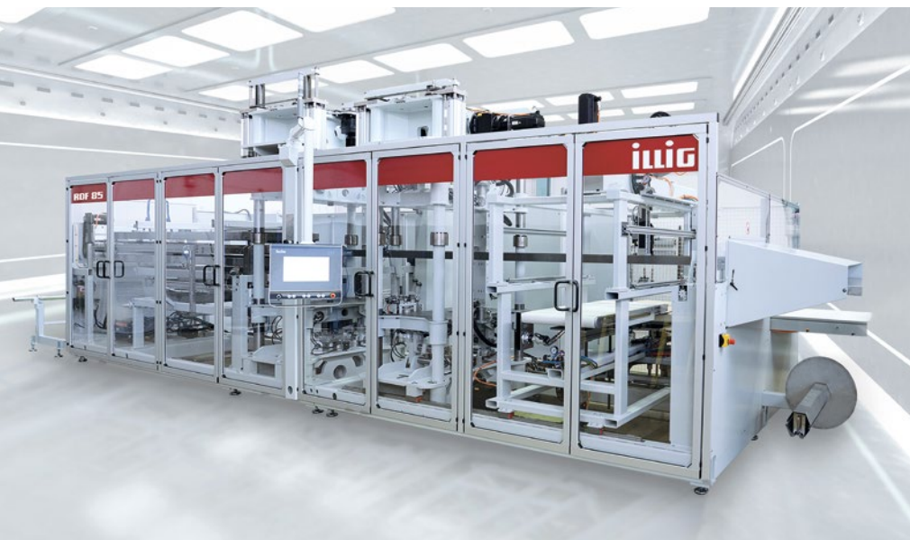
Der Rollenformautomat RDF 85 von Illig kann Trays bis zu einer Größe von 800 x 600 mm fertigen.
