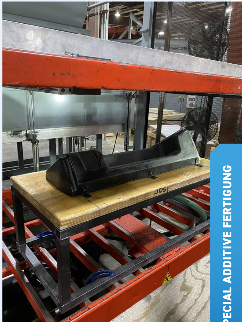
Eine 3D-gedruckte Tiefziehform, gedruckt mit GF-PC-Pellets auf der Titan-Pelletextrusionsplattform von 3D Systems.
