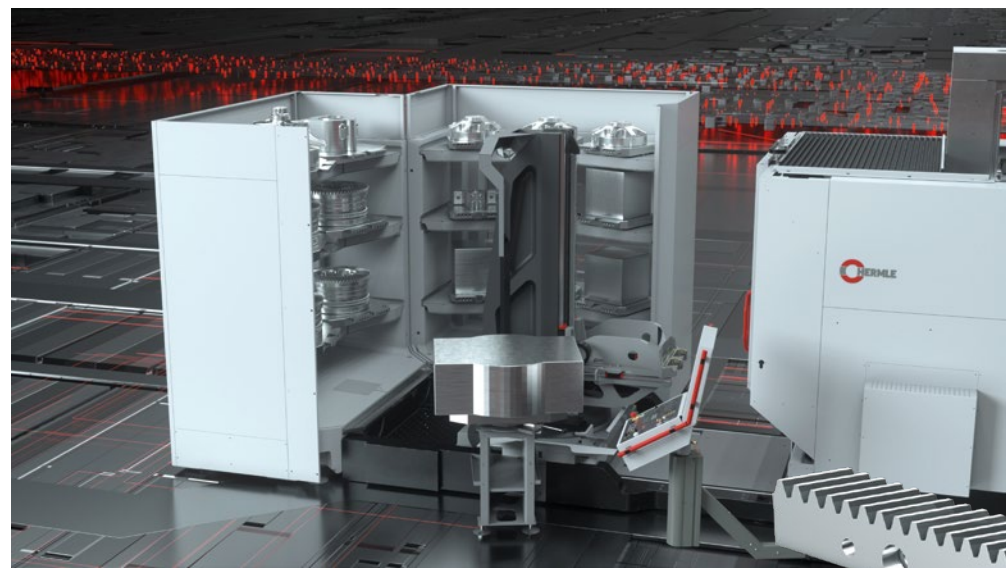
Der Turm im Inneren der Zelle kann Dreh-, Hub- und Fahrbewegungen ausführen. Er beschickt so Rüstplatz, Speichermodule und Arbeitsraum mit den Werkstücken. Bild: Hermle
