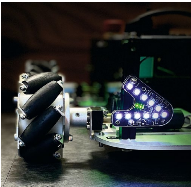
Die Variante mit Mecanum-Rädern ermöglicht es dem Roboter, auf der Stelle zu drehen sowie seitlich oder diagonal zu fahren.
